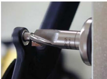
**Planfräsen der Disc-Aufnahmen mit dem Gnann-o-mat Fräswerkzeug von MAGURA**
