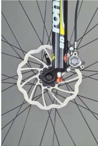
Laufrad-Schnellspanner **IMMER** auf der gegenüberliegenden Seite der Bremszange montieren und mit **MAXIMALER** Spannkraft schließen! Grund: Beim Bremsen entsteht Wärme, und viele Schnellspanner sind Kunststoff-gelagert. Wird dieser durch die Wärme weich, kann sich das Laufrad minimal „bewegen“, was Quietschen provozieren kann.
